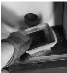
a) Remoção queimador
